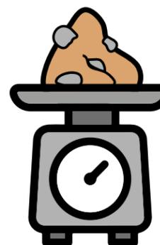
**3** Pase la muestra por un tamiz de 2 000  $\mu\text{m}$  y por uno de 63  $\mu\text{m}$  y pese en la balanza.
